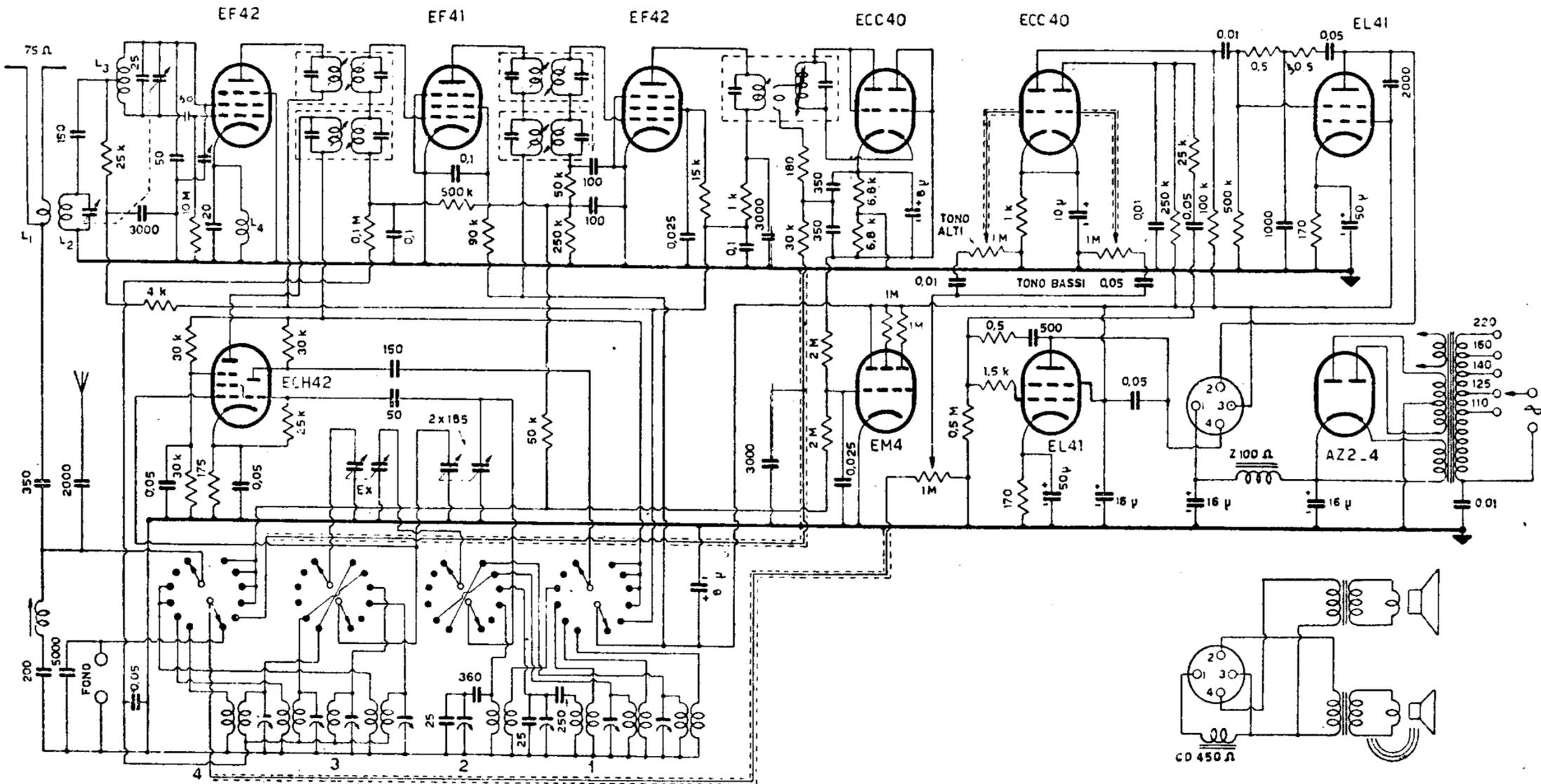
**RADIO RICORDI - Mod. AM/FM 10/50 - Ricevitore a modulazione d'ampiezza e di frequenza, con due canali a bassa frequenza. Media frequenza: 467 kc per AM e 10,7 Mc per FM. Potenza d'uscita 10 watt.**
